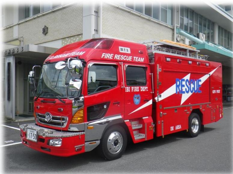
救助活動に必要な資機材と隊員を現場へ運搬する車両。車両本体にはクレーンやウインチ、大型の照明機を備え、交通事故救助から山岳救助、水難救助など幅広く対応する。
