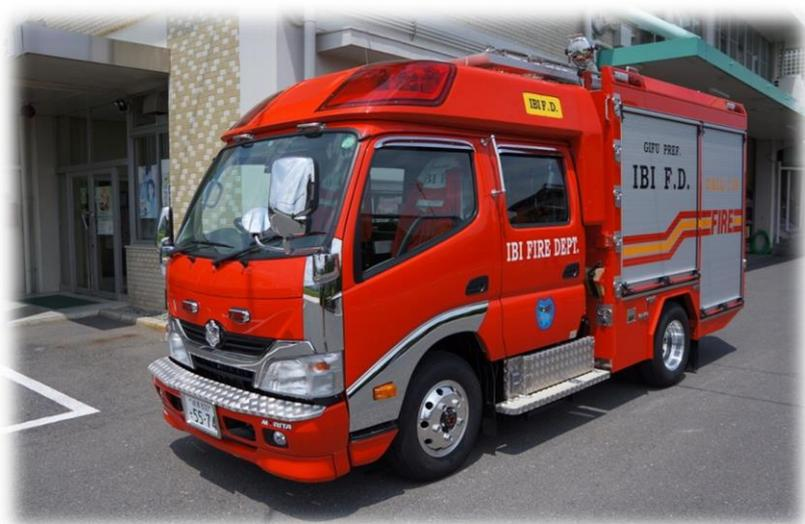
火災時にタンク車とペアを組み出場し、消火栓、河川などからタンク車に水を供給するのが主な役割。また圧縮空気泡消火装置（CAFS）を搭載しており、泡放水が可能な車両。
