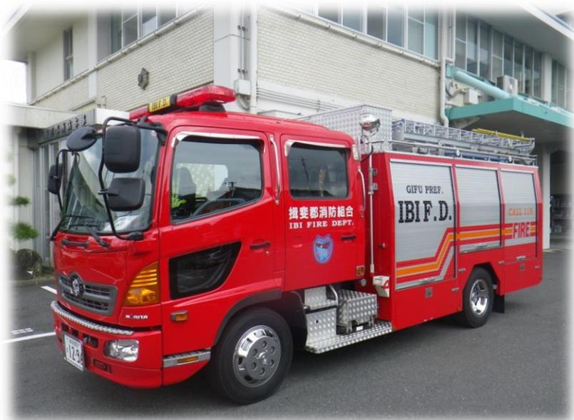
消防活動で必要となる水（2000リットル）を積載している車両。常に火災現場の最前線に位置し火災戦闘に大きな役割を果たす。緊急援助隊登録車両。
