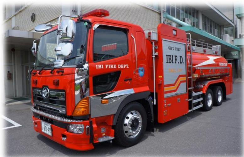
消火活動に必要な水（10000リットル）を積載している車両。大規模災害時には住民への飲料水の供給がおこなえるよう水道カランを装備。C A F S 搭載車両。
